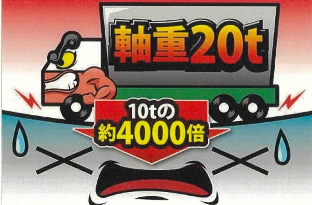
軸重20tの車が走行すると、道路への影響は軸重10tの車の約4000倍になります。
